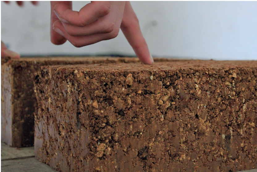
Figura 1. Bloque de tierra comprimida (BTC) sometido a prueba de dureza superficial
